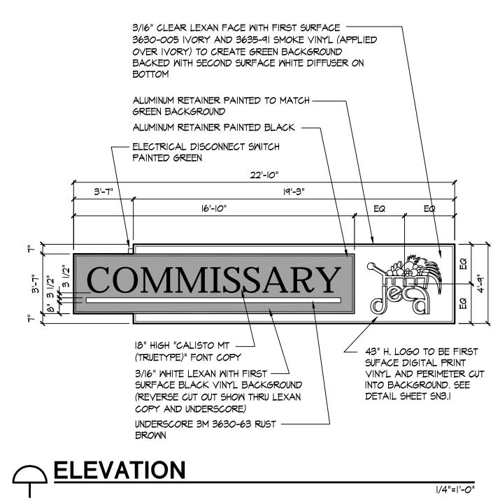
ALUMINUM CABINET LEXAN FACE WITH PAINTED GREEN BLACK BACKGROUND (SHOWN SHADED) ALUMINUM RETAINER PAINTED GREEN ELECTRICAL DISCONNECT SWITCH PAINTED GREEN LEXAN FACE MITH GREEN BACKGROUND ALUMINUM RETAINER PAINTED BLACK - LOGO AND COPY ARE NOT SHOWN FOR (SHOWN SHADED) CLARITY ALUMINUM CABINET - SEE ELEVATION FOR ADDITIONAL DIMENSIONS PAINTED BLACK OF SIGN
